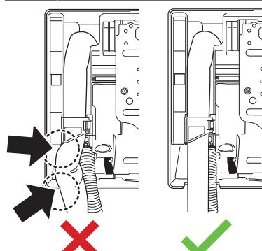
2 Проведіть дренажний шланг та трубки через отвір у стіні і закріпіть отвір ущільнювальною масою.
